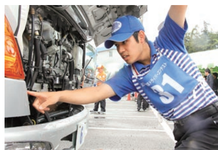
冷却水の点検
