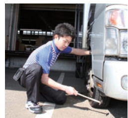
日常点検のひとつ、タイヤの空気圧チェック
