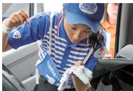
エンジンオイルの点検
